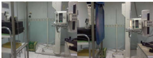
Gb 3. Pengukuran Laju dosis sebelum melewati lead apron (D0) (A) dan setelah melewati lead apron (Dt) (B)
