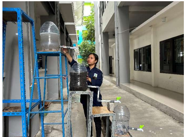
Pemasangan alat filtrasi sederhana menggunakan galon Le Mineral
