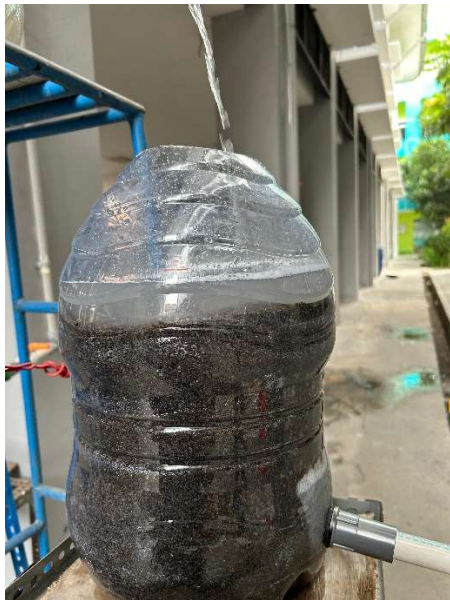
Filtrasi menggunakan media pasir
