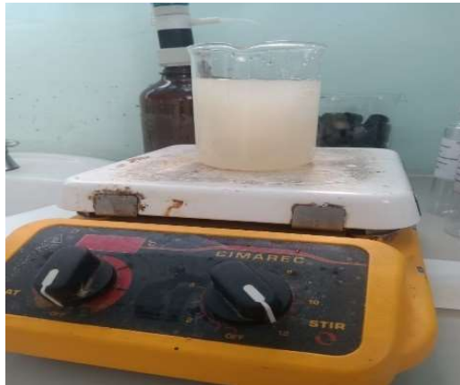
Pengadukan Limbah laundry dengan magnetic stirrer
