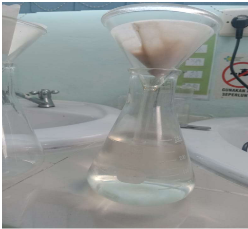
Proses Penyaringan sampel menggunakan kertas saring
