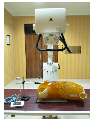
Gambar 1. Positioning Body Phantom dan detektor Raysafe X2
