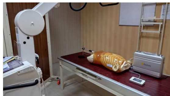
Gambar. 2. Posisi Pengukuran Radiasi Menggunakan Phantom
